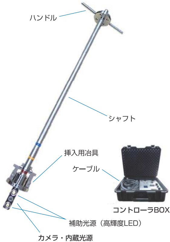
図3 シャフトカメラの構造
