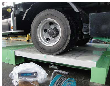
図4 実車両載荷試験状況
