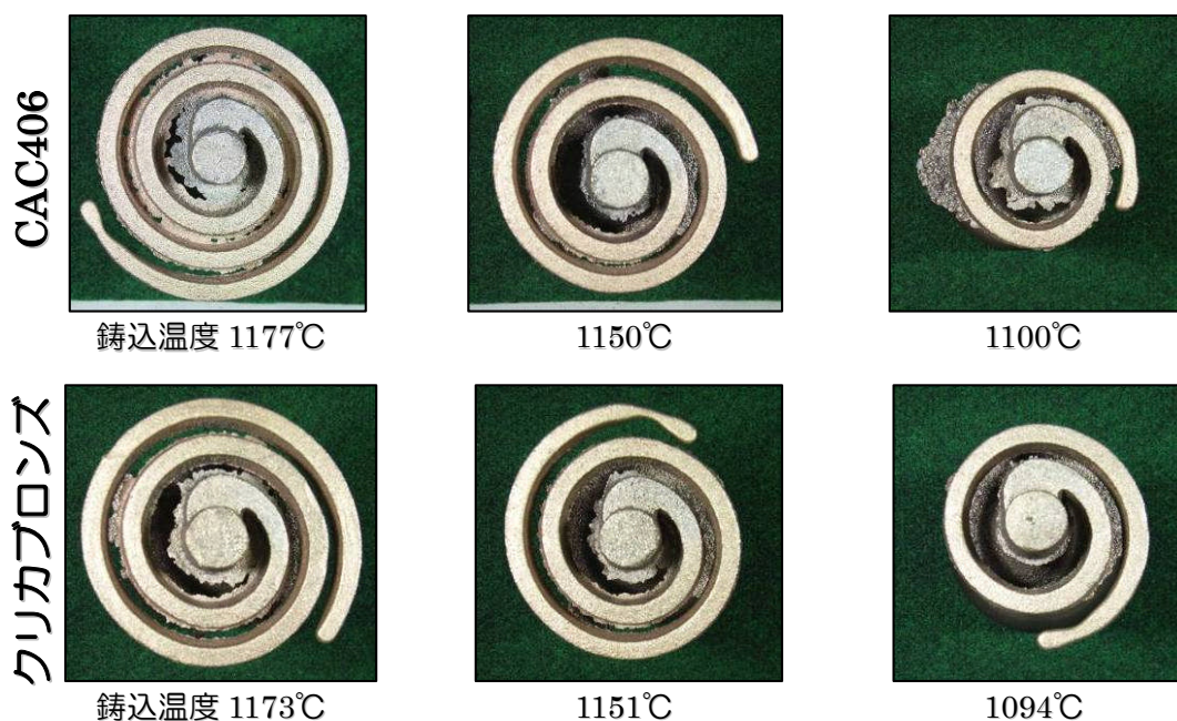
図 5-1 CAC406 とクリカブロンズにおける渦巻き供試材の鑄込温度と流動性比較 (測定例)
