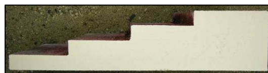
(c) クリカブロンズ(Cu-4.1Sn-7.1Zn-1.6Bi-2.0Ni-0.031P, mass%)
