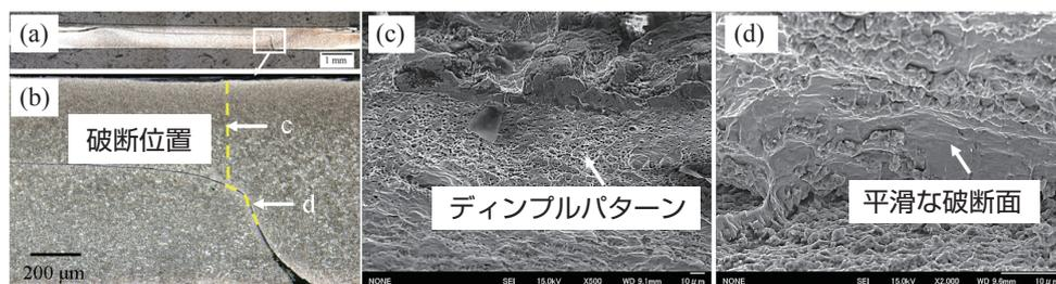
図11 破断箇所の説明写真および破断面のSEM写真
