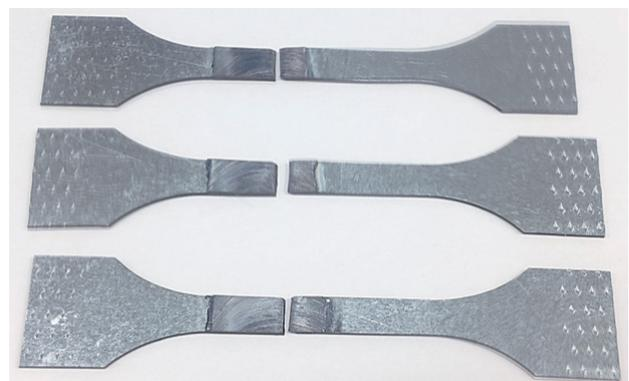
図10 引張試験後サンプルの外観写真
