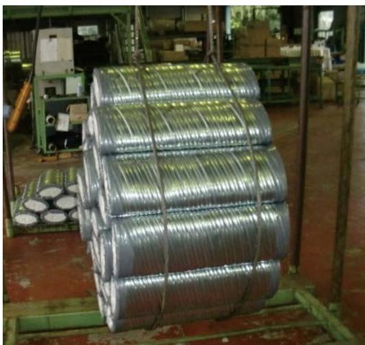
図9 揚重時の試験体状況
