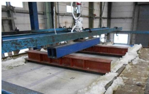
図6 耐火試験中の試験体状況
