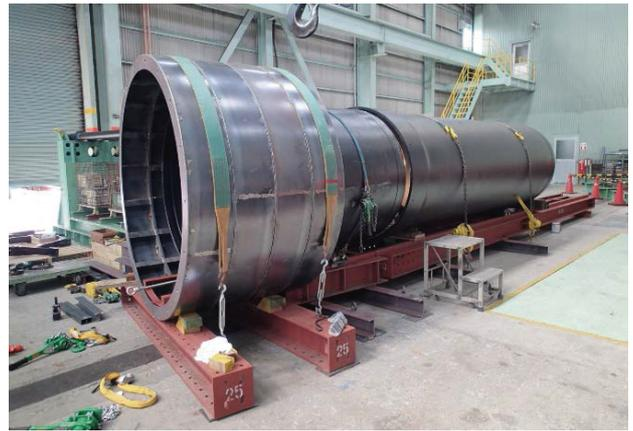
図28 曲管継手接合試験状況 (全景)
