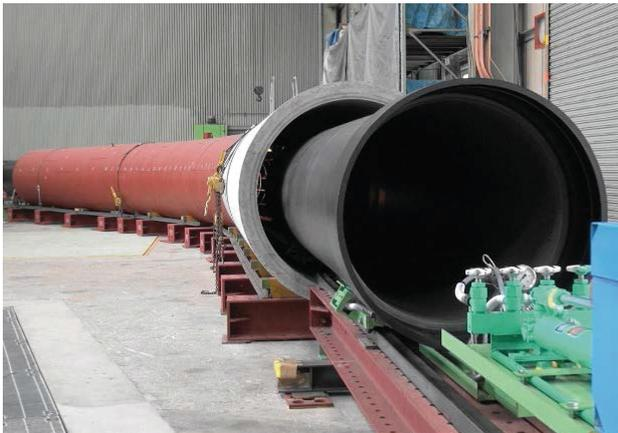
図8 急曲線部通過試験状況 (全景)
