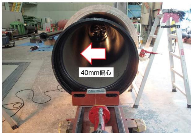
図26 受口を40mm偏心させたドッキングの模擬試験状況
