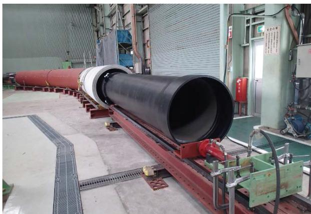
図22 ドッキングの模擬試験状況 (全景)
