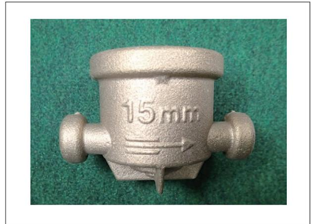
図5 金型鑄造試作例 海外水道メーター
