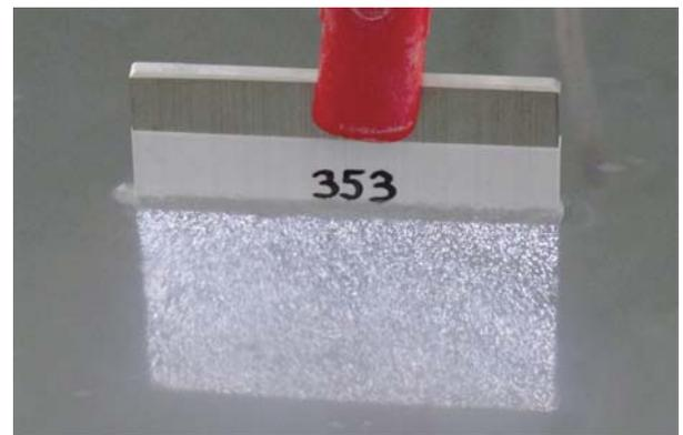
図1 プラズマ電解酸化の様子
