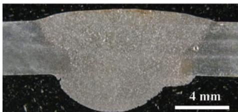
図29 HRR AZ31B溶接部断面マクロ組織
