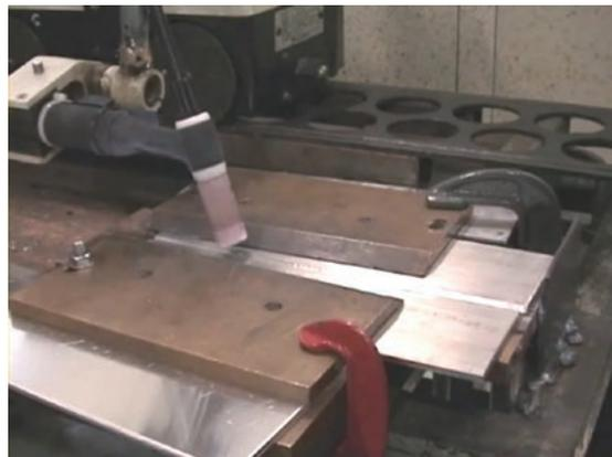
図26 ティグ溶接時の試験片固定方法
