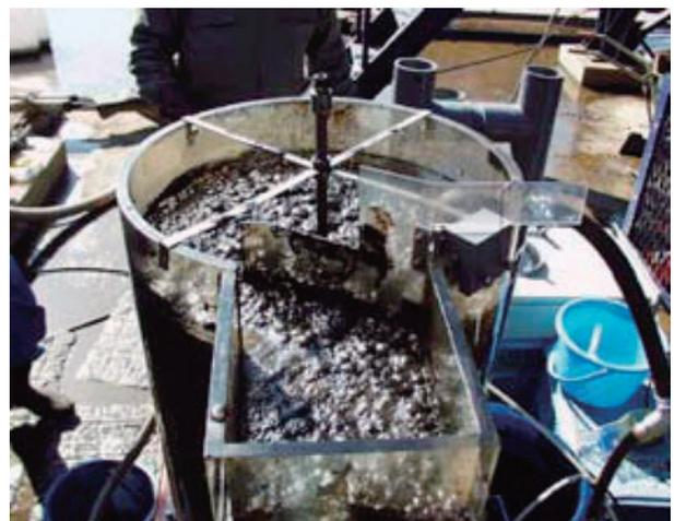
図4 油汚染土壌排水から分離された油分泡沫
