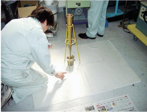
図3 コンシステンシー試験
