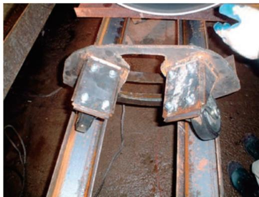
図3 鋼管用挿入台車
