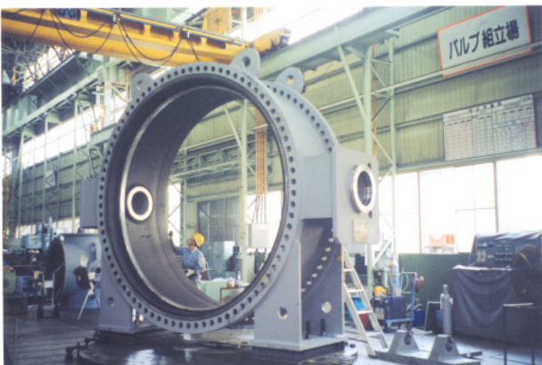
図2 弁箱の据え付け
