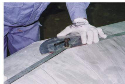
図9 中心線の合わせ目角度の測定
