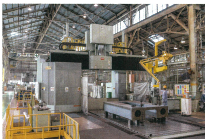
五面加工機 最大積載荷重 40ton
