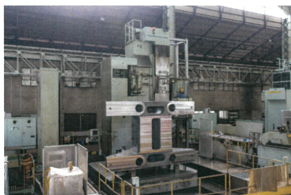
横中ぐり盤 最大積載荷重 130ton
