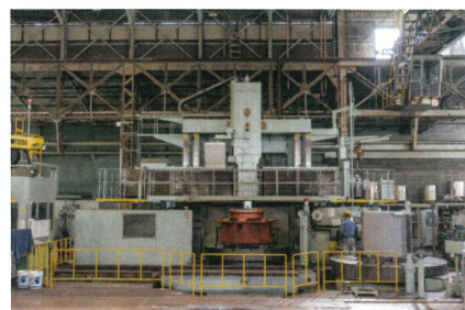
ターニングセンタ 最大積載荷重 20ton
