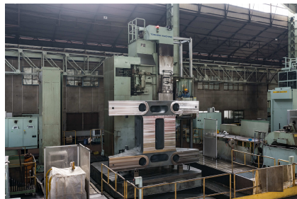
横中ぐり盤 最大積載荷重 130ton
