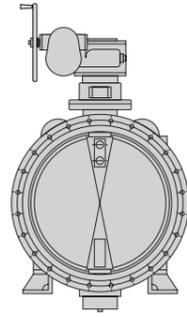
■ 水道用バタフライ弁 (ゴムシート型)
