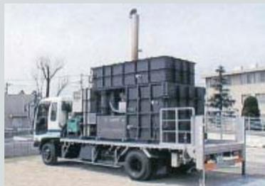
炭化物製造車(煙突立ち上げは炭化時のみ)
