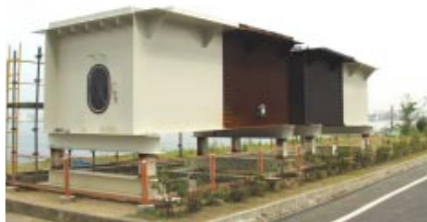
当社大阪臨海工場に設置した実証実験桁
