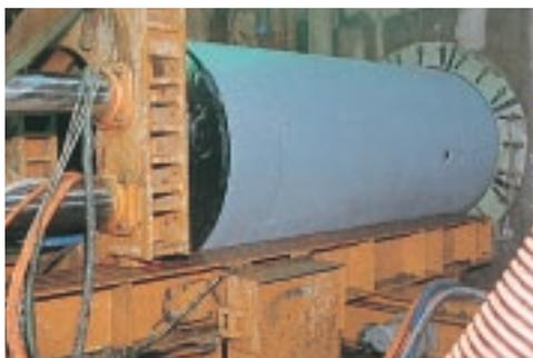
推進工法用ダクティル鉄管
